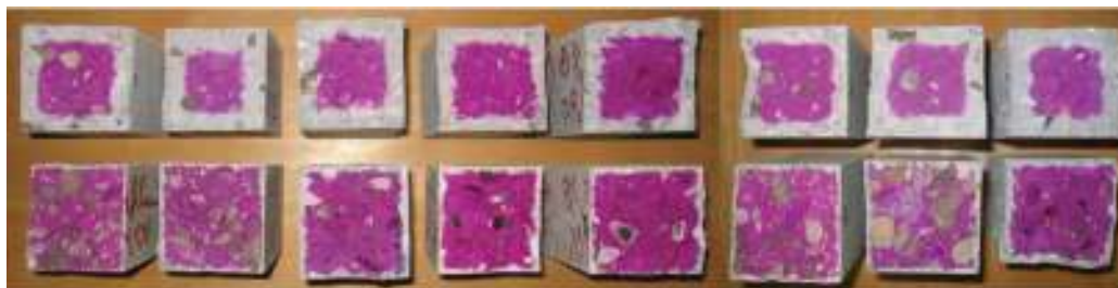
شکل ۲- تاثیر عمل آوری بر عمق کربناسیون بتن- ردیف بالا عمل آوری با رطوبت ۵۰ درصد، ردیف پایین ۲۴ ساعت عمل آوری داخل آب
