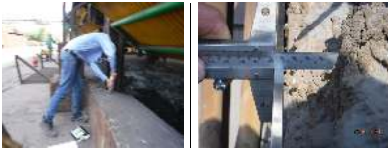
شکل ۵ - اندازه گیری ابعاد هندسی ناحیه خورده شده
