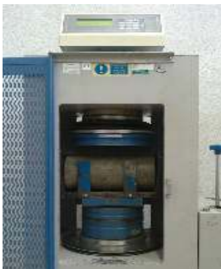
شکل ۵- آزمایش مقاومت کششی غیر مستقیم
