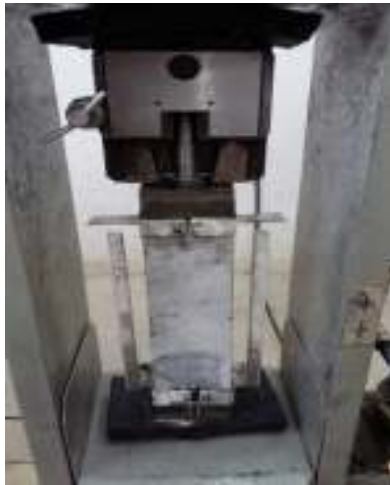
شکل ۸- جزییات و نحوه‌ی قرارگیری نمونه در دستگاه کشش مستقیم
