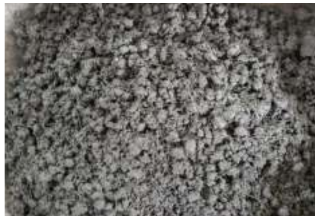
شکل ۹- نمونه‌ای از اختلاط کامل کلیه مصالح با یکدیگر
