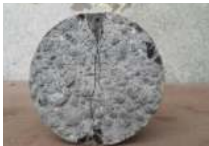
شکل ۱۴- نحوه شکست نمونه‌ها با و بدون الیاف تحت آزمایش کشش غیرمستقیم
