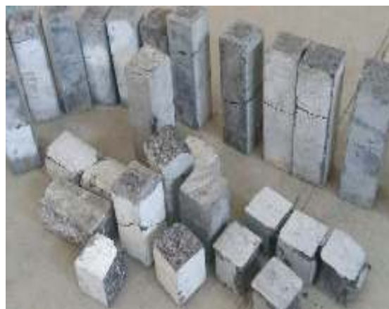
شکل ۱۱- شکست تعدادی از نمونه‌های منشوری بتن سبک تحت کشش مستقیم
