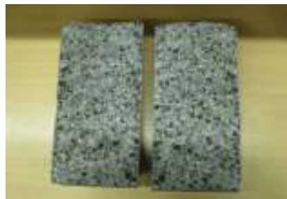
شکل ۱۴- نحوه شکست نمونه‌ها با و بدون الیاف تحت آزمایش کشش غیرمستقیم
