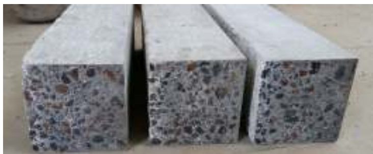
شکل ۷- آماده سازی سطح نمونه‌ها جهت انجام آزمایش کشش مستقیم
