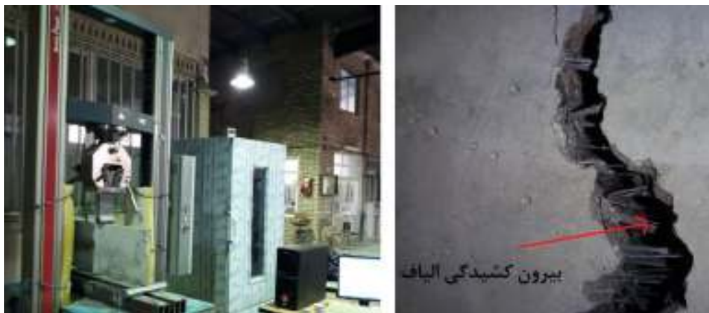
شکل ۴- تصویری از یک نمونه در حال آزمایش (سمت چپ) و سطح شکست بتن پس از آزمایش (سمت راست).
