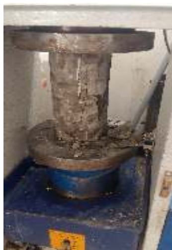
شکل ۳: آزمون مکعبی ۲۰ در ۲۰ و استوانه‌ای ۳۰ در ۱۵ تحت آزمایش مقاومت الکتریکی
