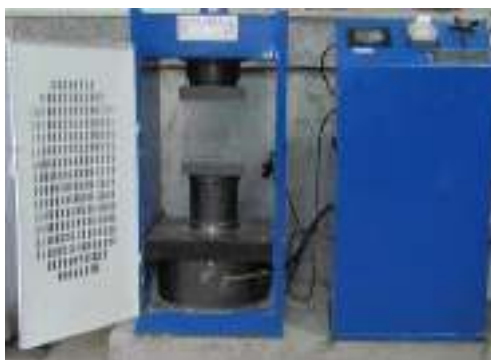
شکل ۲- جک شکننده ی نمونه های بتن ترکیبی
