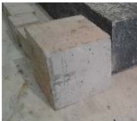
شکل ۴- تصویر نمونه ساخته شده بتن ژئوپلیمری بر پایه متاکائولن
