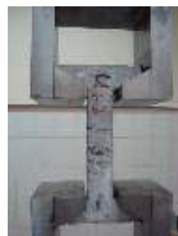
شکل ۱۹- نمونه استخوانی شکل تحت بارگذاری کشش مستقیم توسط دستگاه MTS
