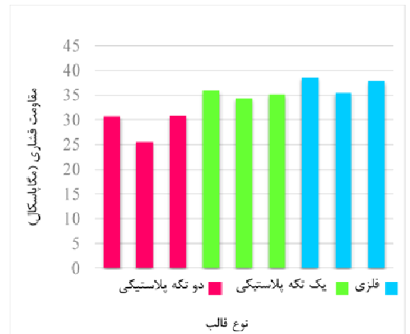
شکل ۱۴- میانگین مقاومت فشاری نمونه‌های ۲۸ روزه با عیار 400 \text{ kg/m}^3
