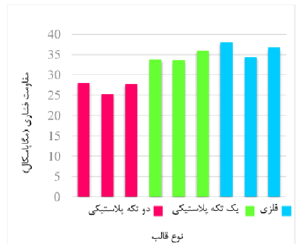
شکل ۱۰- میانگین مقاومت فشاری نمونه‌های ۷ روزه با عیار 450 \text{ kg/m}^2
