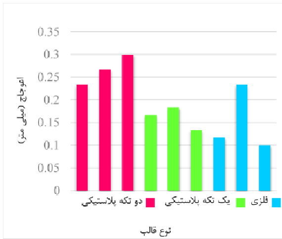
شکل ۹- میانگین حداکثر اعوجاج نمونه‌های ۷ روزه با عیار 400 \text{ kg/m}^2
