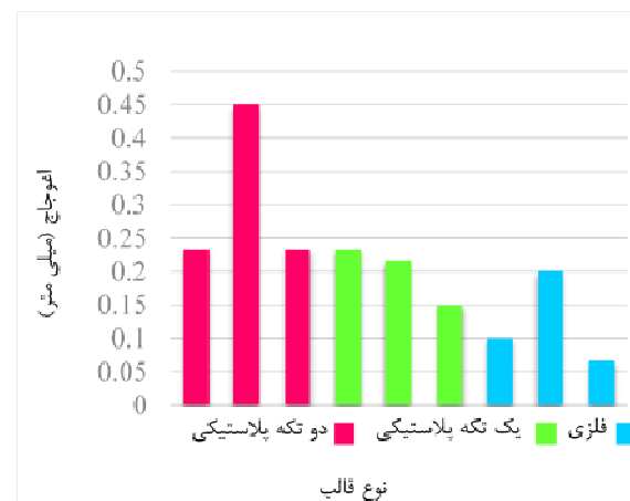
شکل ۱۳- میانگین حداکثر اعوجاج نمونه‌های ۲۸ روزه با عیار 350 \text{ kg/m}^2
