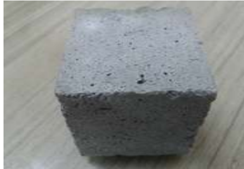
شکل ۴- تصویر نمونه ساخته شده بتن ژئوپلیمری بر پایه خاکستر بادی
