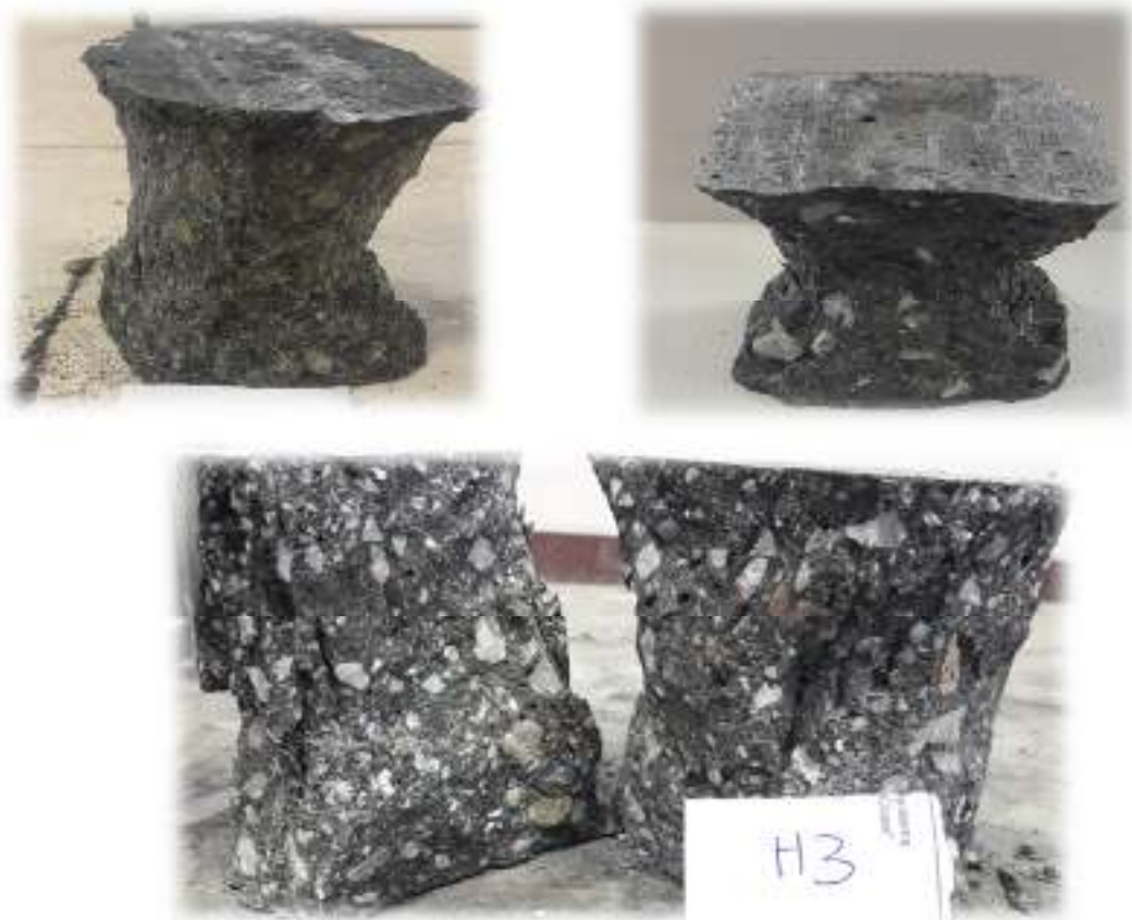
شکل ۳- نمونه ای از شکست آزمونه‌ها بالا راست: نمونه حاوی درشتدانه کوراتز، بالا چپ: حاوی گارنت، پایین: سیلیس
