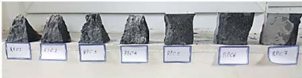
شکل ۱- نحوه شکست نمونه‌های ۲۸ روزه
