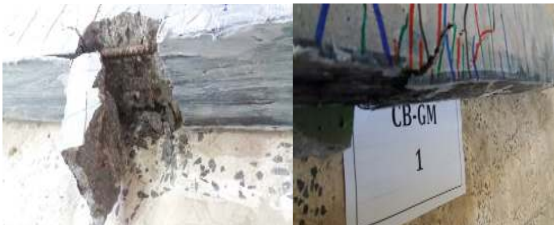
ب) مود شکست تیرهای بتن سبک فاقد الیاف و بتن معمولی در مطالعه مدندوست و رحیمی [۲۲] شکل ۳-۳: مود شکست تیرهای بتن مسلح تقویت شده به روش GM
