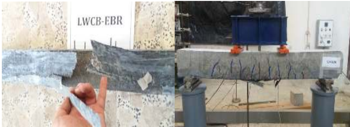
ب) مود شکست تیرهای بتن سبک فاقد الیاف و بتن معمولی در مطالعه مدندوست و رحیمی [۲۲] شکل ۲-۳: مود شکست تیرهای بتن مسلح تقویت شده به روش EBR
