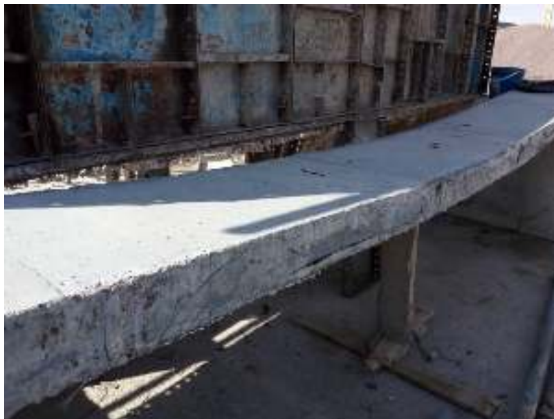
شکل ۴- تغییر شکل اولیه دال بتنی با ۱ لایه ورق GFRP
