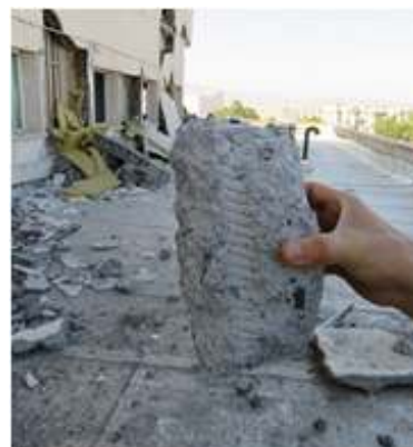
شکل (۲۵) - عدم وجود درشت دانه در یک تکه جدا شده از بتن
