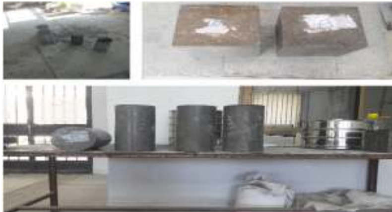
شکل ۳- نمونه‌ها پس از بتن‌ریزی
