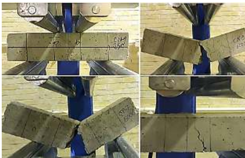
شکل ۴- تصاویری از روند انجام آزمون مقاومت خمشی
