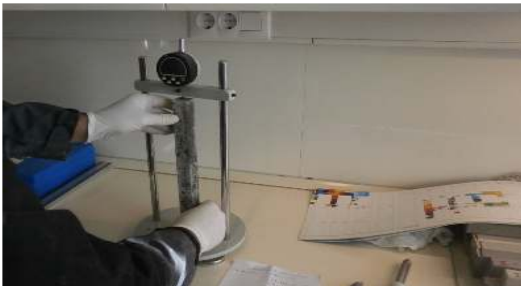
شکل ۳- قرائت طول منشور های ملات به وسیله دستگاه مقایسه کننده طولی
